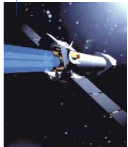
Computer-Grafik des Röntgenobservatoriums XMM. Drei parallele Röntgenteleskope suchen gleichzeitig das All nach kosmischen Strahlenquellen ab. (Quelle: ESA)
