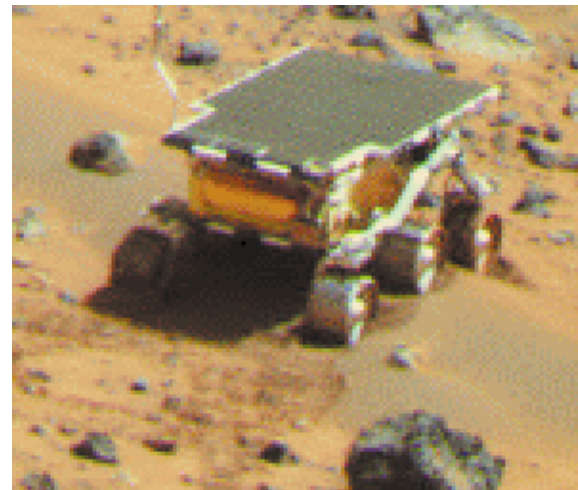
Das Mars-Fahrzeug Sojourner. Mit seiner „Schnüffelnase“ konnten die Planetenforscher die chemische Zusammensetzung von Gestein und Staub auf dem Roten Planeten analysieren. (Foto: NASA/MPG)
