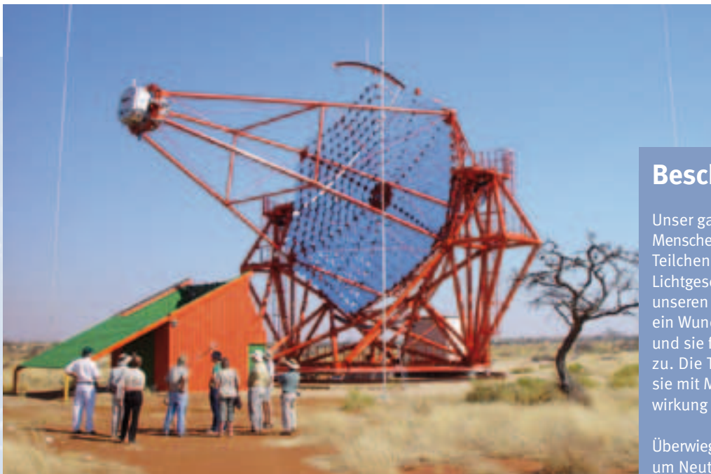
▲ Die H.E.S.S.-Teleskope in Namibia spüren der Kosmischen Gammastrahlung nach, in dem sie die von der Strahlung in der Atmosphäre ausgelösten Teilchenschauer verfolgen. (Bild: H.E.S.S. collaboration)
