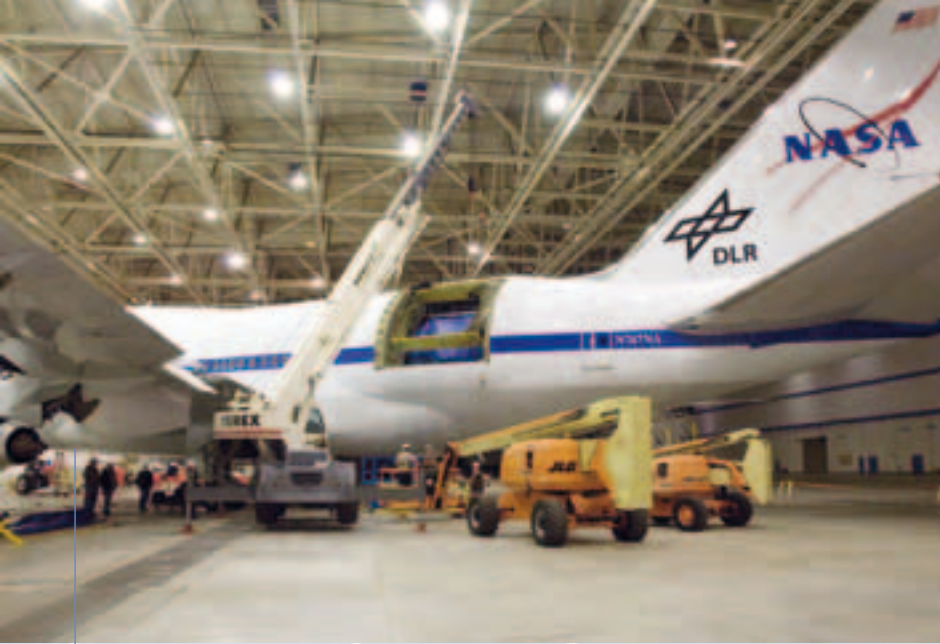
▲ Techniker bereiten das Einsetzen eines Teleskopspiegels in den Rumpf einer umgebauten Boeing 747 vor. Unter dem Namen SOFIA soll das fliegende Observatorium ab Frühjahr 2010 in 12 bis 14 Kilometer Höhe seine Arbeit aufnehmen. (Bild: NASA Photo/Tony Landis)
